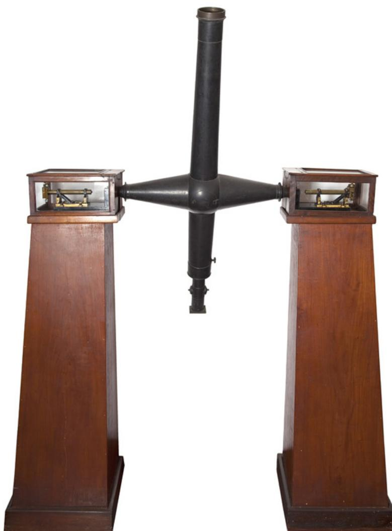
Figura 1 - Luneta meridiana de fabricação inglesa (Dollond).
